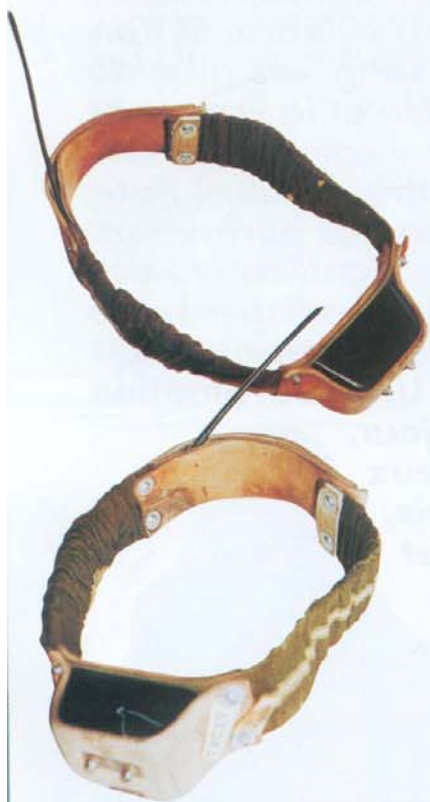
Ce collier émetteur possède une partie extensible qui s'ajuste en fonction de la croissance de l'animal
